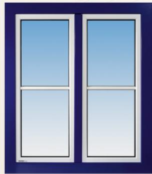
Die Außenseite des Holz-Alufensters ist durch beschichtetes oder eloxiertes Aluminium witterungsbeständig. Zwei Stockdichtungen und eine Überschlags-Flügeldichtung sowie das Wärmeschutz-Isolierglas garantieren eine hohe Schall- und Wärmedämmung.
