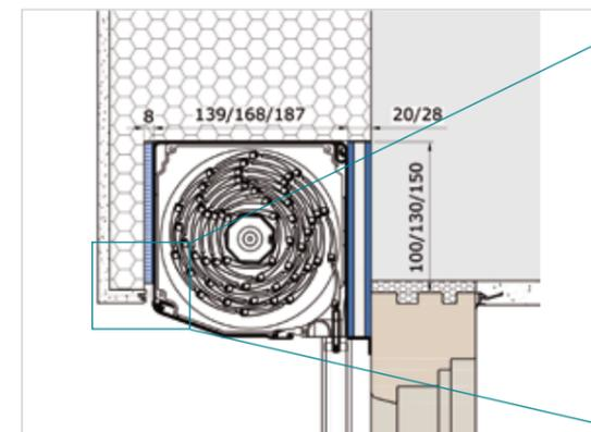
Mit Wärmedämmverbundsystem und Sturzdämmung
