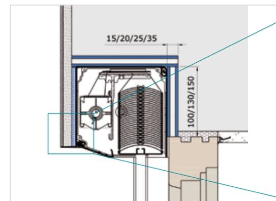
Mit Sturzaussparung und Sturzdämmung
