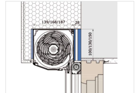
Mit Wärmedämmverbundsystem und Sturzdämmung
