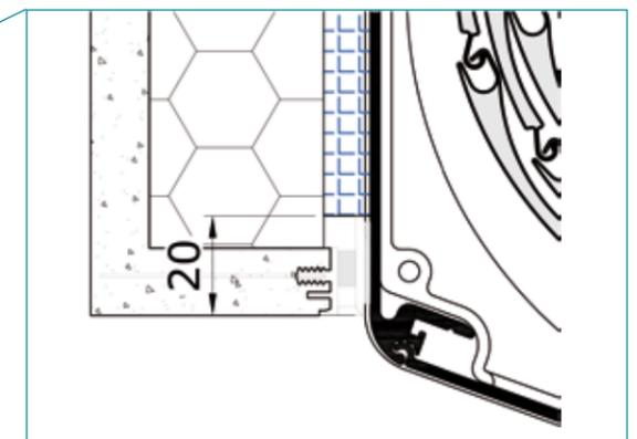
Sonderausführung für Wärmedämmverbundsystem
